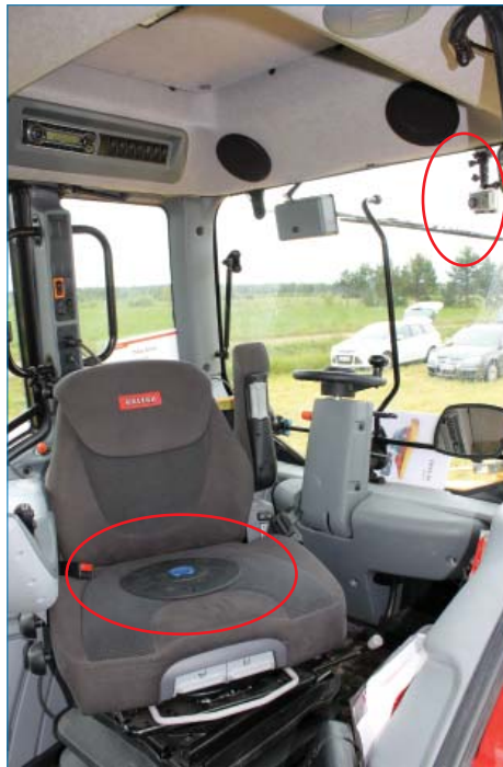
Työasentotutkimusta varten kuljettajan työasennot kuvattiin pienoiskameran avulla. Kehotärinäaltistus mitattiin istuimelle asennetun tärinäanturin avulla.
