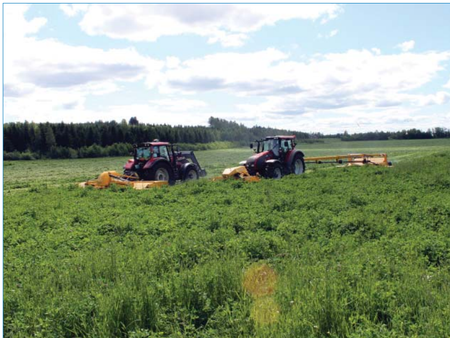
Molemmissa traktori-työkoneyhdistelmissä kuljettajan istuimesta mitattu keskimääräinen värinä jäi selvästi alle kehotärinän toiminta-arvon 0,5 m/s 2 .
