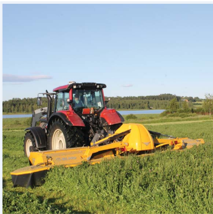
Taakseajoniitossa työkohte on hyvin kuljettajan näköpiirissä, mikä helpottaa työskentelyä. Kuvat: Markku Lätti
