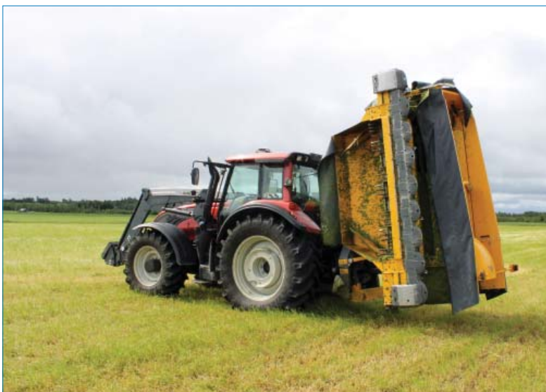
Kuljetuksen ajaksi niittomurskaimen murskainyksiköt saadaan nostetuksi ylös yhdellä napin painalluksella.
